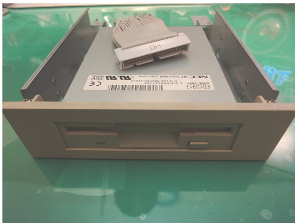
PC-FD321DH 5 インチベイカバーと FD1231T、ケーブル、ねじのセットだが、FD1231T はフロントカバーが搭載されている特別なモデル。
