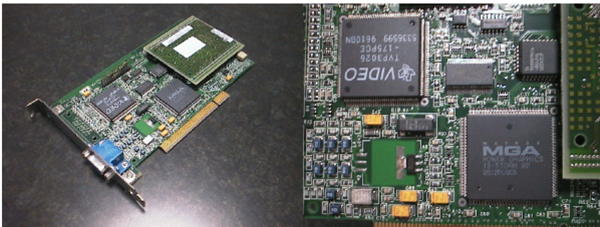
MGA-Millennium。写真は OEM 向けの RAMDAC 175MHz モデル。オンボード 2MB+増設メモリ 2MB の 4MB 仕様
