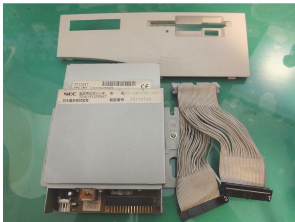
PC-9821RA-FD01 専用フロントパネルと FDD (FD1231T)、取付金具 (上下)、FD 分岐ケーブルのセットです。
