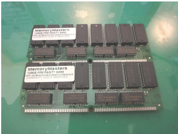
128MB/枚 2 枚で 256MB のメモリセット。EDO-ECC SIMM ではなく FastPage SIMM。
