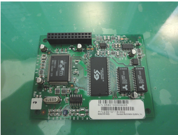
Diamond MultimediaSystems MonsterSound 搭載の GS 対応 MIDI ドーターボード (WaveBlaster 互換品)
